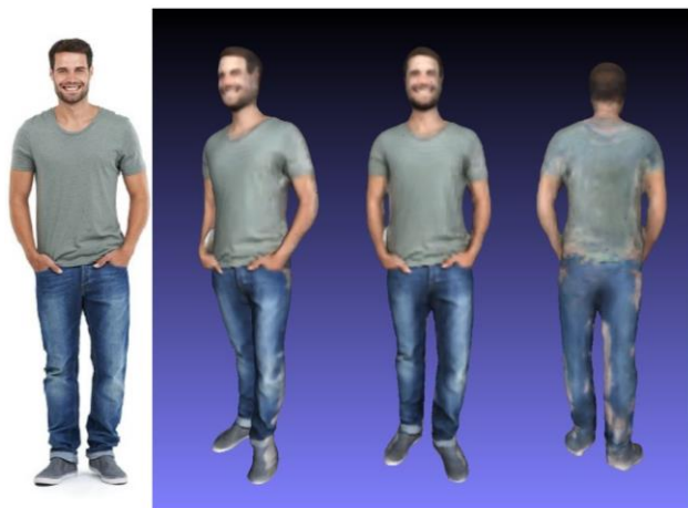
Hình 11: Kết quả mô hình 3 chiều cơ thể người được sinh ra sử dụng mô hình PIFu. a) Ảnh đầu vào, b) Mô hình 3 chiều ở các hướng nhìn khác nhau
